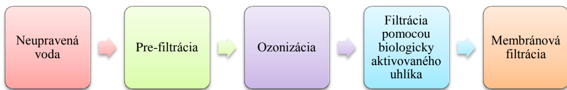
Obrázok 6: Proces úpravy pitnej vody pri kombinácii ozónu s biologicky aktívnym uhlíkom a membránami [29]
