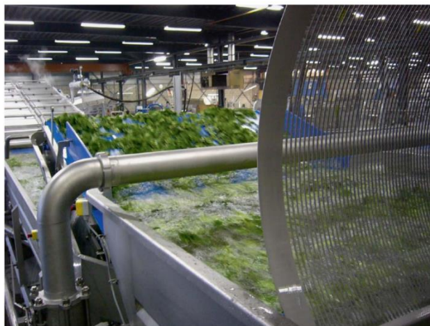
Obrázok 2: Umývacia linka slúžiaca k ošetrovaniu povrchu zeleniny za pomoci ozónu [8]
